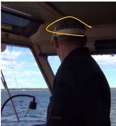
Bild 1. Observationer filmades. Personen på bilden har en rörelseindikator monterad på ett huvudband som mäter antalet nackrotationer per minut. Foto AMMnorr
